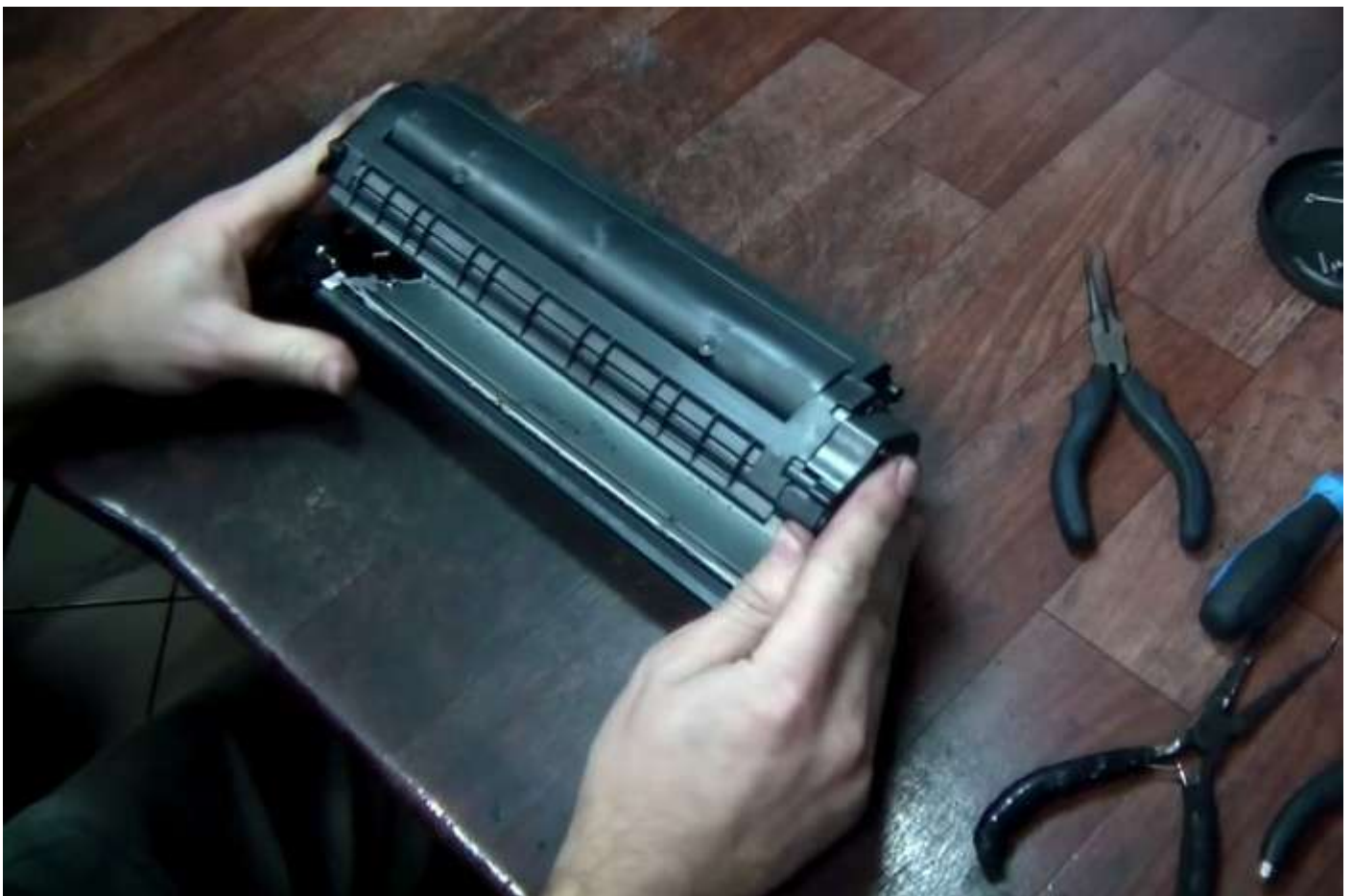
Снимаем вторую пружинку, которая держит защитную шторку.
