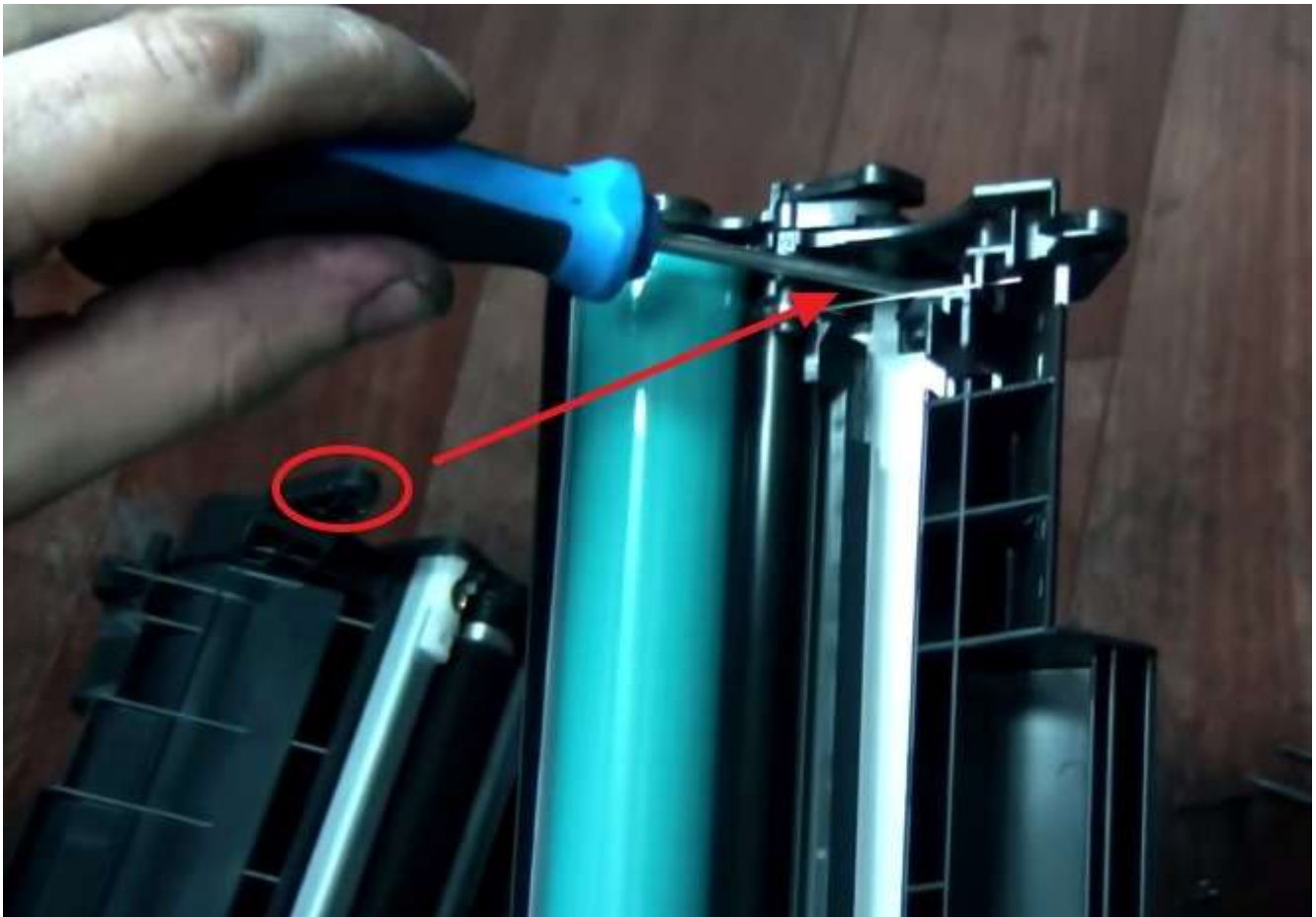
Отдвигаем шторку и устанавливаем штифт.
