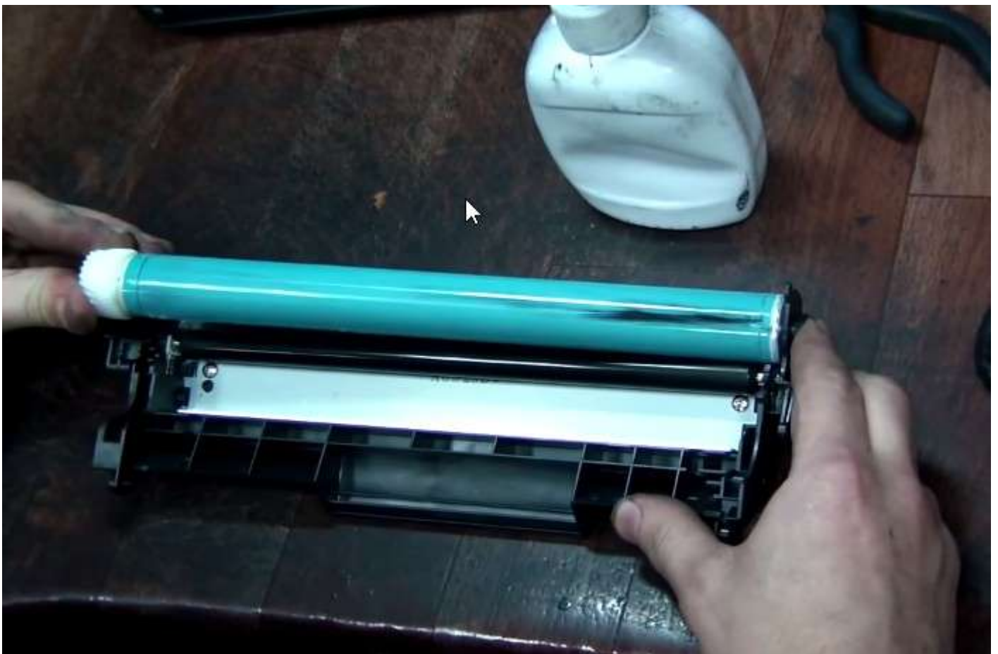
Устанавливаем боковую крышку, которая держит фотобарабан.
