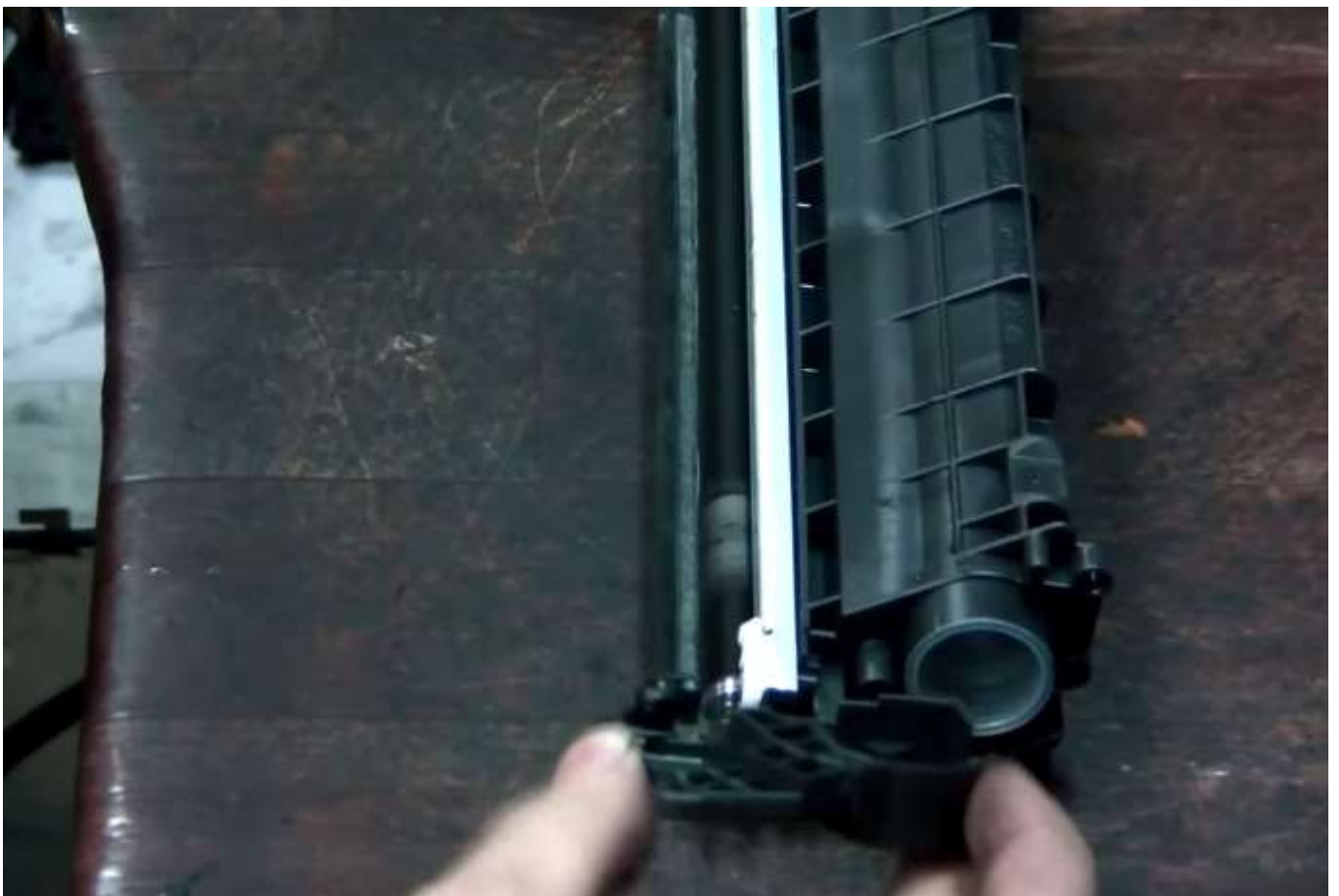
Приподнимаем одну сторону магнитного вала и снимаем бушинг.
