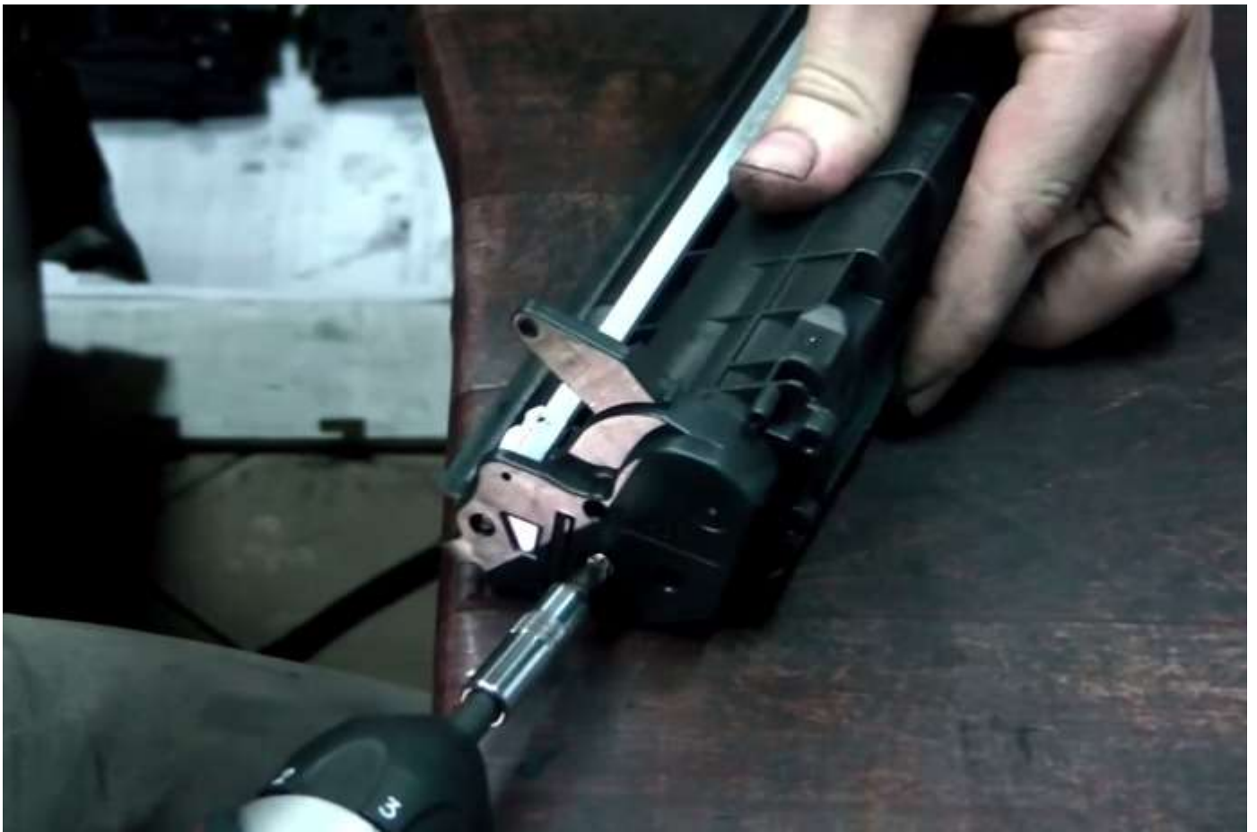
Снимаем боковую крышку.
