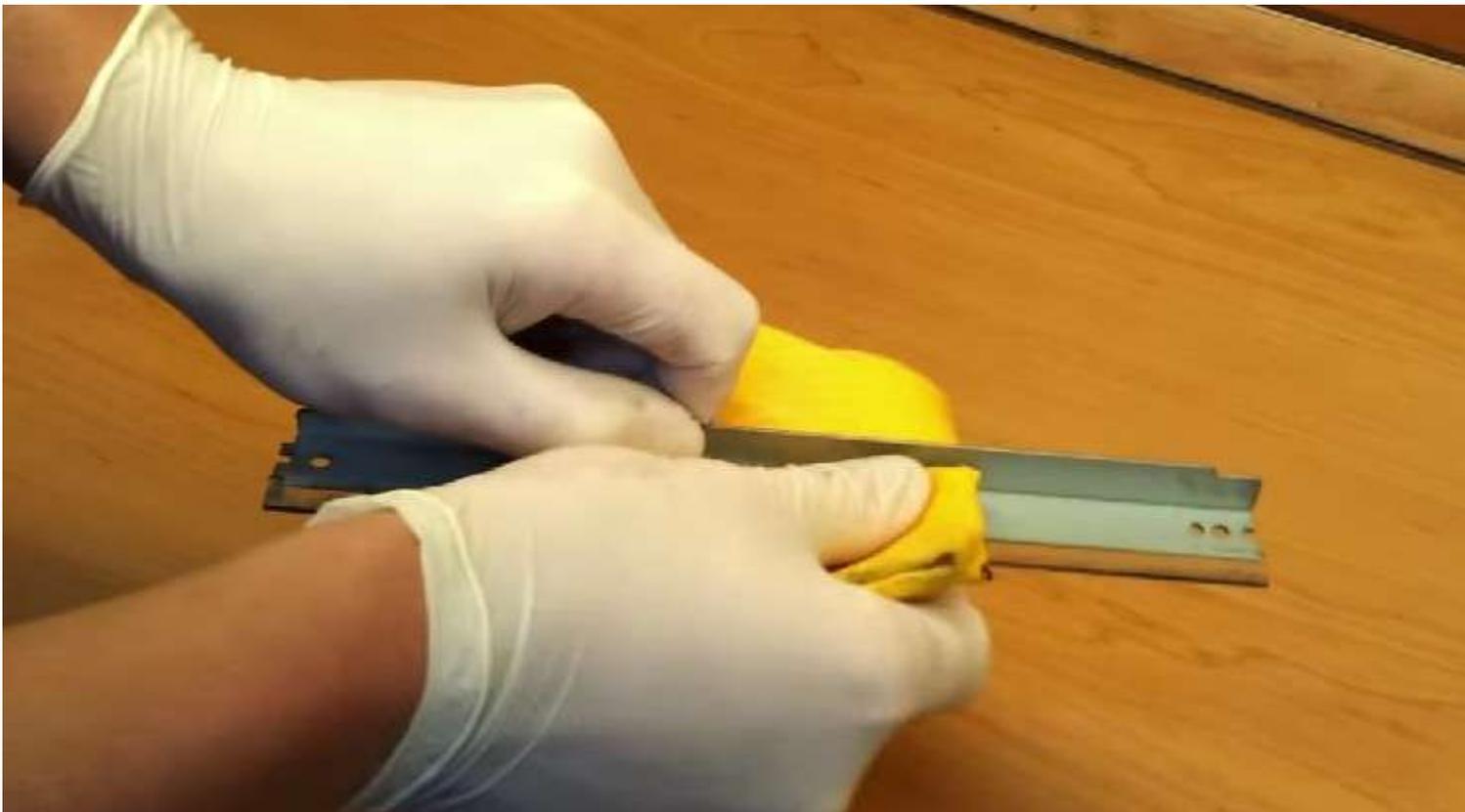
Пылесосим бункер с отработанным тонером.
