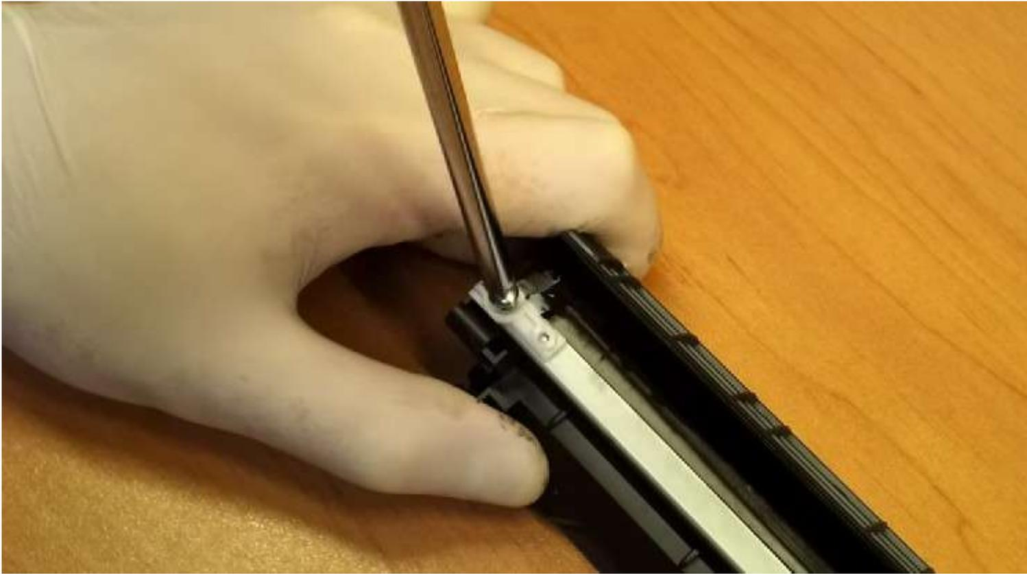
Снимаем пластиковые крепления по бокам лезвия, а затем снимаем само лезвие с помощью прямой отвертки.
