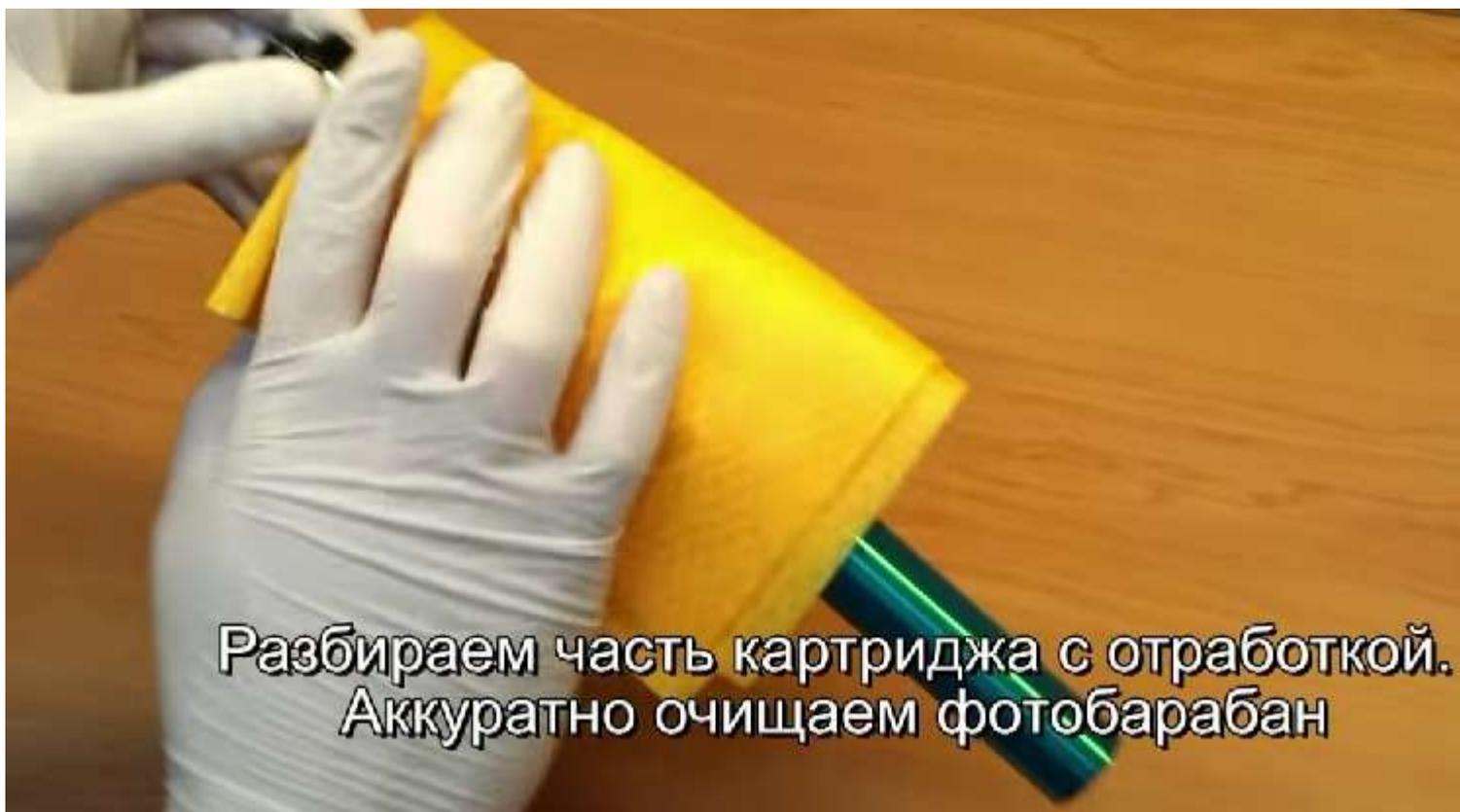
Разбираем часть картриджа с отработкой.
