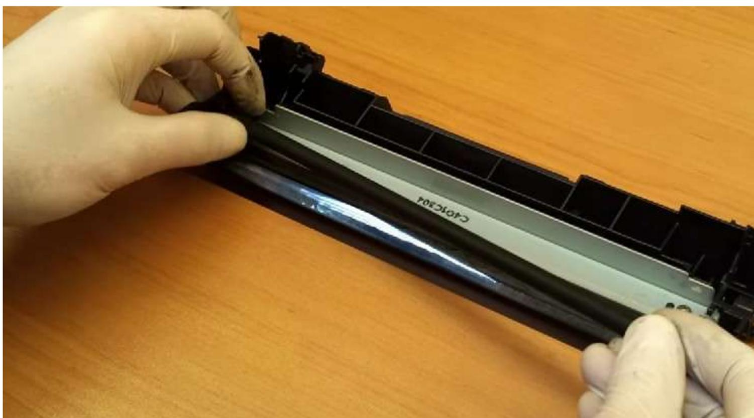
Смазываем трущиеся места токопроводящей смазкой.
