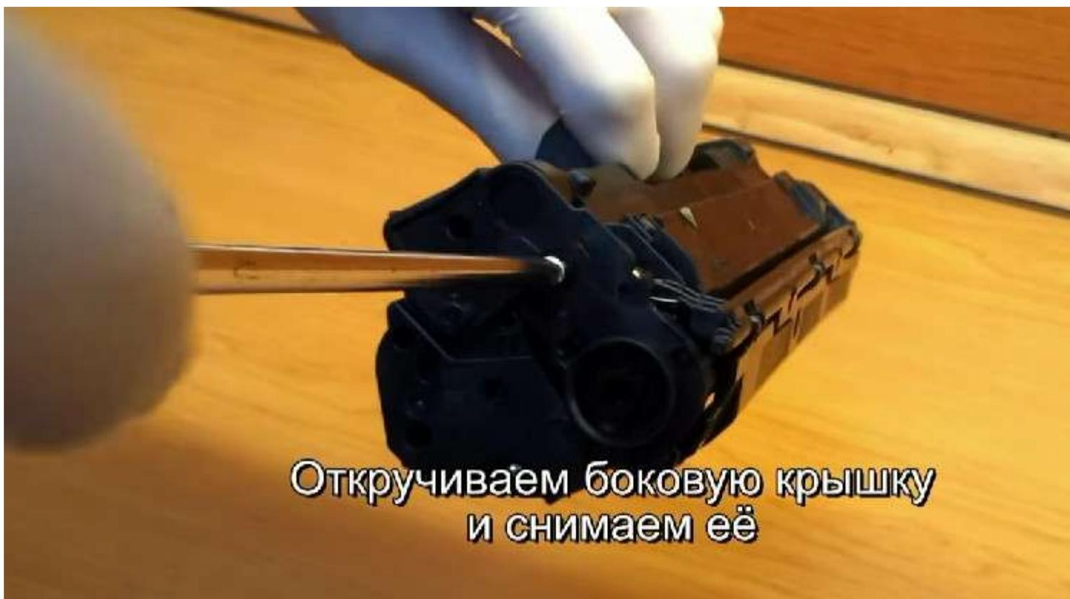
Снимаем боковую крышку и заводим пружинку в положение показанное на рисунке ниже.
